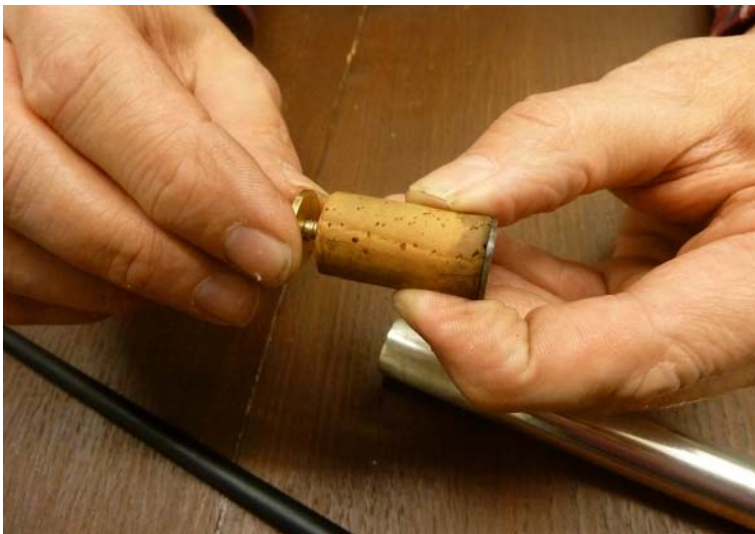
Kuvat 7 ja 8: Kierrä levyt tiukalle korkin molemmin puolin.
