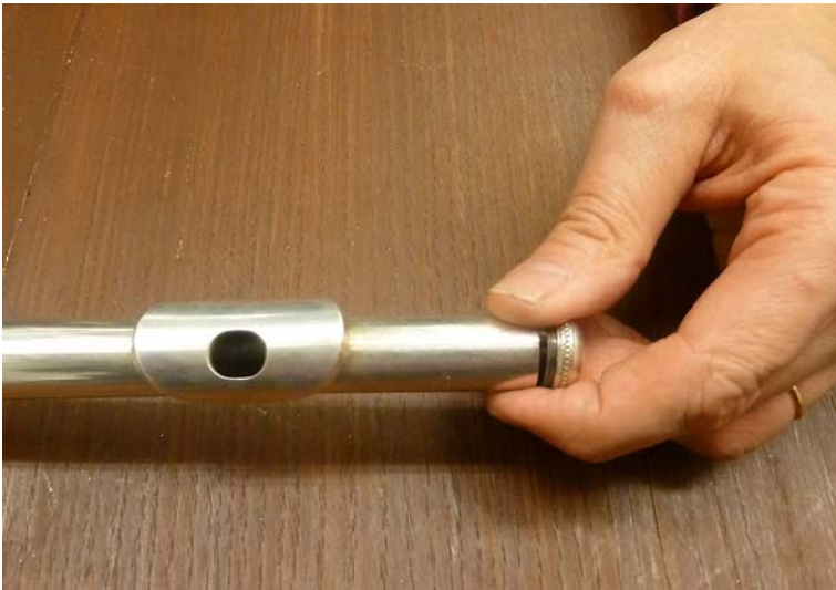
Kuva 4: Jos korkki on siirtynyt liian ulos, niin avaa suukappaleen päässä olevaa ruuvia muutama millimetri ja työnnä ruuvilla korkki takaisin niin, että puikon ura on keskellä aukkoa.
