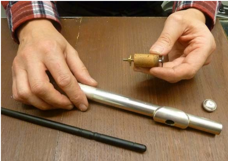
Kuva 6: Avaa päätyruuvia ja työnnä korkkia suukappaleen leveämpää päätä kohden.
